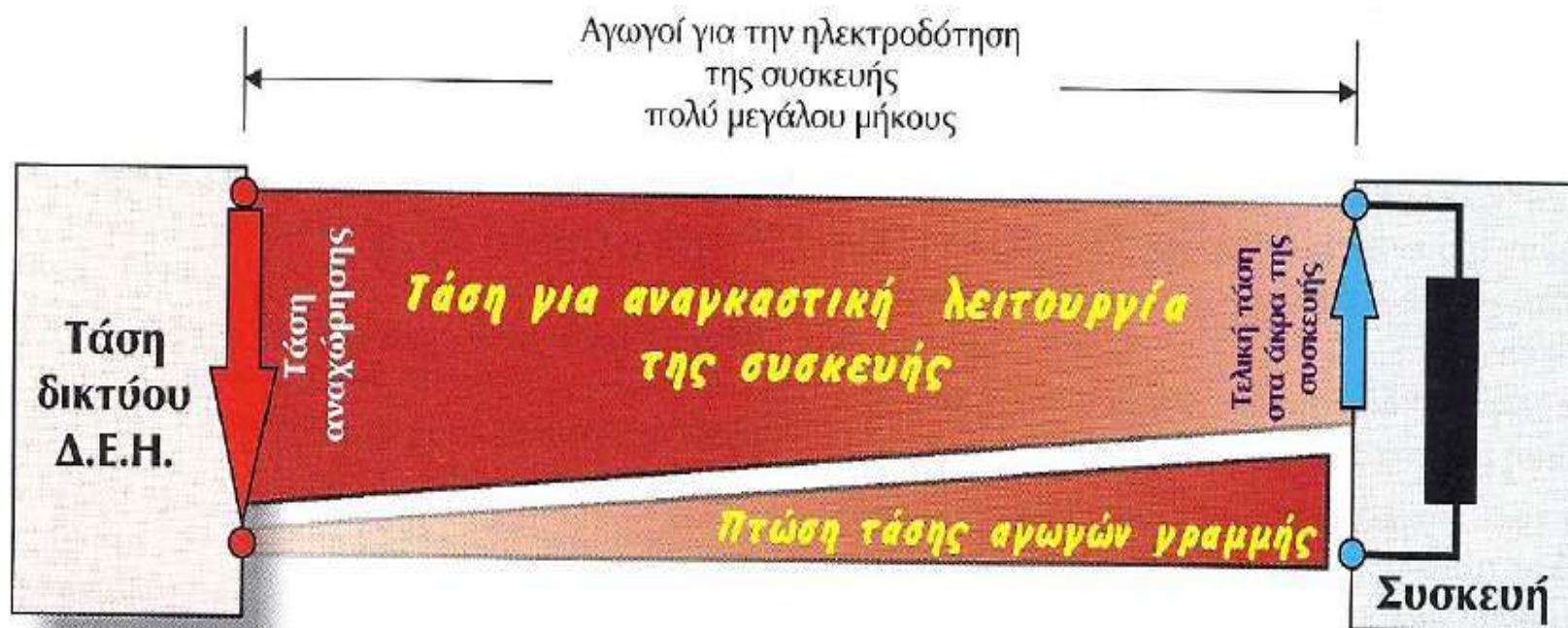
Σχήμα 6.22 Σχηματική παράσταση επηρεασμού της λειτουργίας μιας συσκευής από την αναπτυσσόμενη πτώση τάσης της ηλεκτρικής γραμμής τροφοδοσίας.
